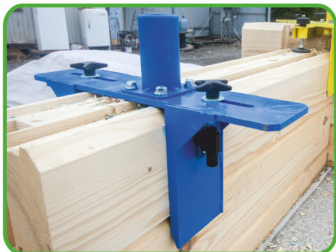
Оснастка «Скрытая электропроводка»
